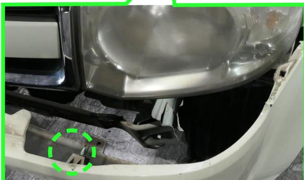
解体作業時に取り外しがしやすい構造になっているよ。
