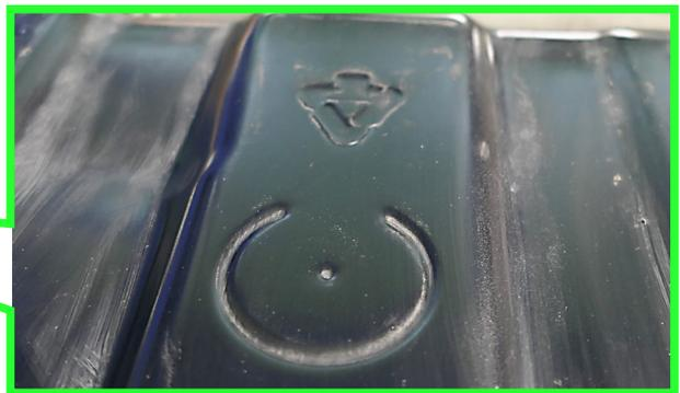
平面になっているからブーツが密着して、燃料が漏れずに回収できるようになっているんだね！
