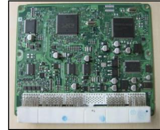
解体工程で取り外した部品(一次分別)からカバーを外して基板を回収する。
