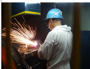
写真左:触媒を溶断機で切断中
