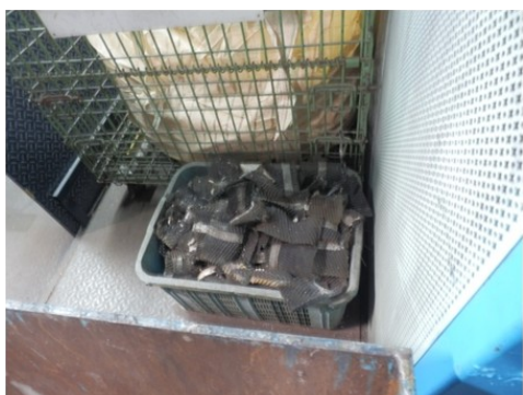
写真右: 触媒内の網状のステンレス鋼も分別されて保管
