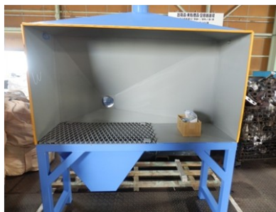
写真左: 切断中に発生した塵も回収できる作業台。
