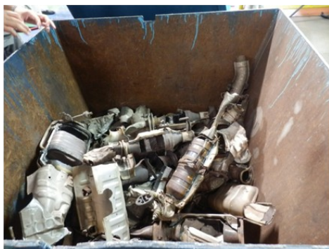
写真右: 切断された触媒のカバーです
