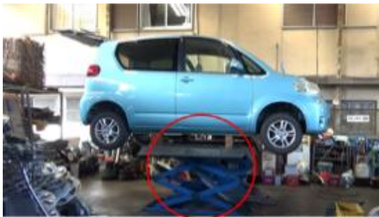
図 3-12. 車台の作業高さの工夫
