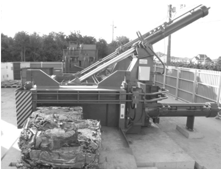
50PAL型/廃車・ガサ物用三方締プレス機
