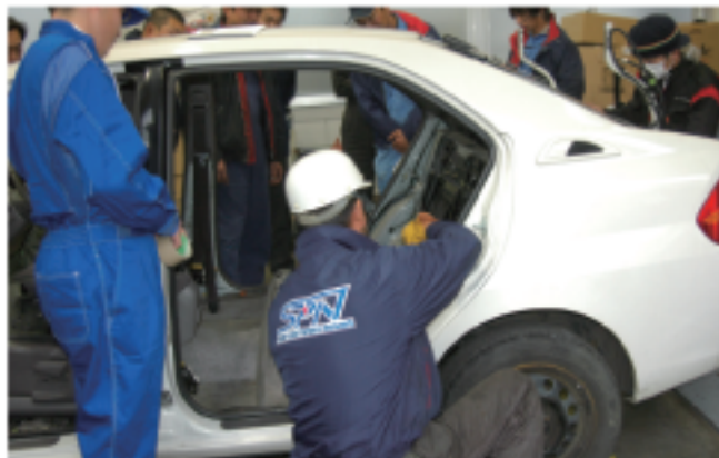
東北ブロック インストラクター講習会における ハイブリッド車バッテリー取り外し研修風景
